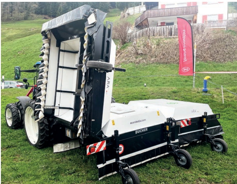
Die Sensoren dieser Feld-Maschine können Unkraut von gesundem Gras unterscheiden.
