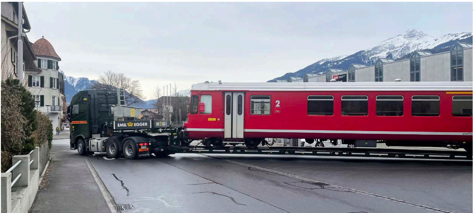
Der RhB-Steuerwagen tritt von der Werkstätte in Landquart die Reise nach Filisur an. Ein nicht alltäglicher Transport, um die Verkehrsinseln und um die engen Kurven wurde es knapp. Fotos S.
