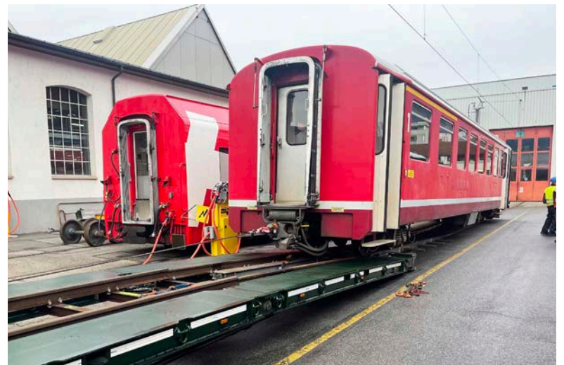
Der Bahnwagen wird auf den Tieflader verschoben.
