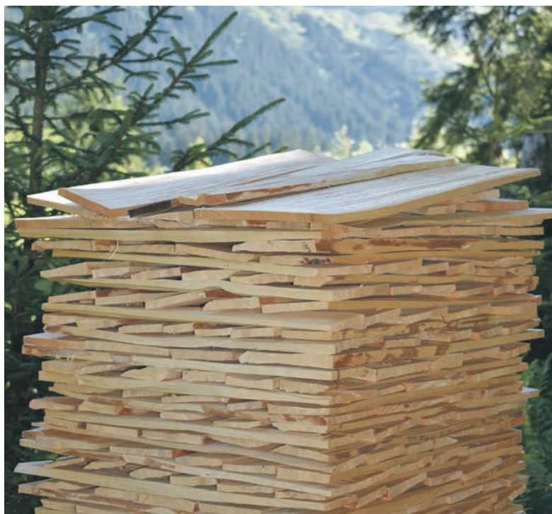
Die fertigen Schindeln werden fein säuberlich gestapelt. Pro m 2 werden rund 40 Schindeln gelegt.
