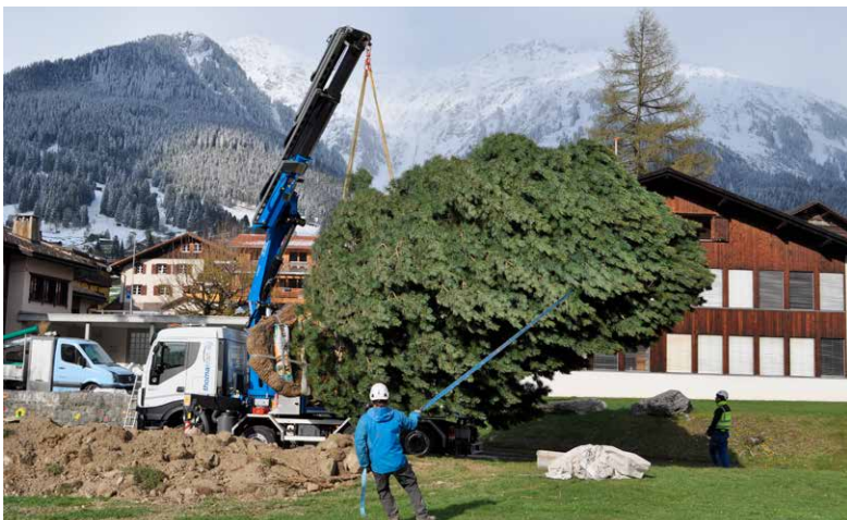
2. Durch das geringe Wurzelballenvolumen verlagerte sich das Gewicht Richtung Krone, was das Aufladen erschwerte.
